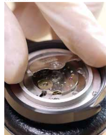
Das Werk wird im Gehäuse fest verschraubt. Im nächsten Schritt wird der Rotor aufgesetzt und fixiert. Die darunterliegende Feder wird bei den Armbewegungen des Trägers durch den Rotor in kleinen Schritten selbstständig aufgezogen.
